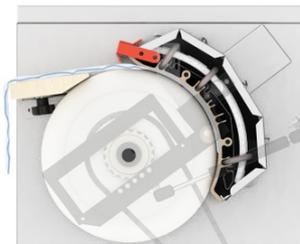
**S-160-30 AVL**, además del control de velocidad del rodillo y de la extracción de condensados, tiene la cubierta del rodillo hecha de **resortes de acero MAXPRESS®** y una capa filtro **NOMEX®**, que permiten el planchado de lino con un contenido de humedad de hasta el 40-45%.
