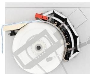
**S-200-30 AVL**, además del control de velocidad del rodillo y de la extracción de condensados, tiene la cubierta del rodillo hecha de **resortes de acero MAXPRESS®** y una capa filtro **NOMEX®**, que permiten el planchado de lino con un contenido de humedad de hasta el 40-45%.
